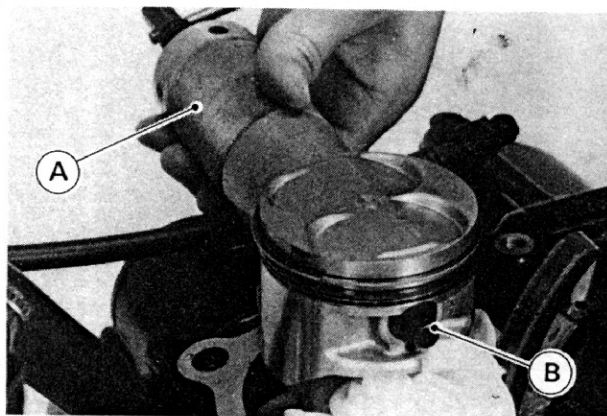
A. Kolbenbolzen-Abziehwerkzeug: 57001-910
